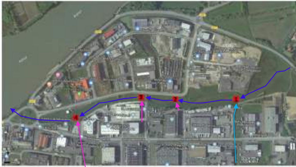
Figure 19 Localisation des sorties pluviales vers le grand canal (en violet : busage ; en bleu : ciel ouvert)
